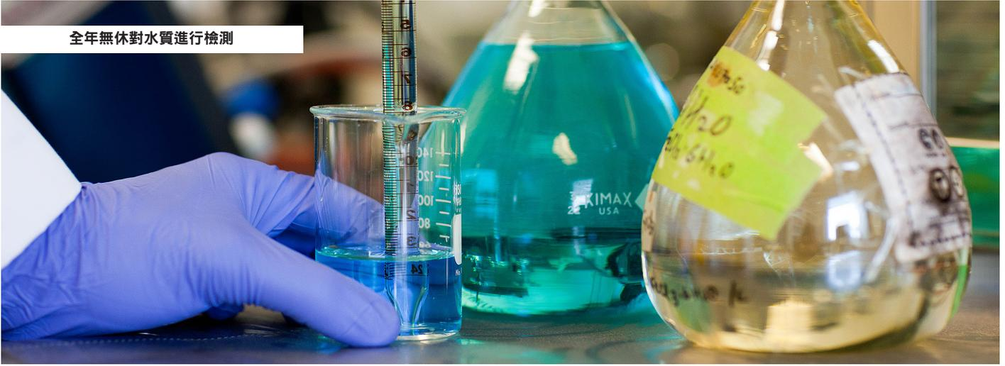
化驗室**全年無休**，負責廣泛分析水樣的各項參數。化驗室會在集水區（早期預警河流水況變化）、水處理過程中的各個階段（優化水處理流程並符合規定標準）、以及卡加利市內配水系統的各處（保證公眾健康）廣泛採集水樣。當水質發生變化或發生其他不可預知的狀況時，工作人員就會增加水樣採集和分析的頻率，並增設更多的監測點。
